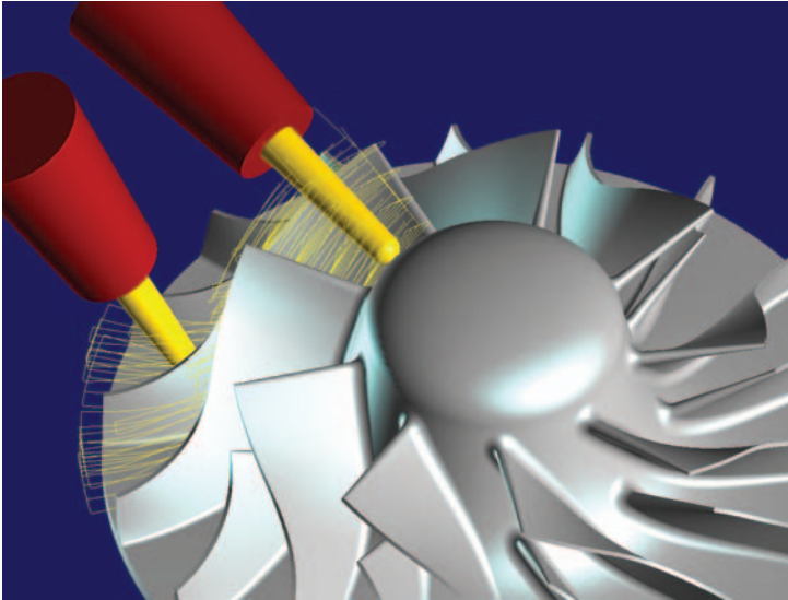
Abb. 1: Simulation 5-Achs-Fräsen mit hyperMILL® der OPEN MIND Technologies AG
