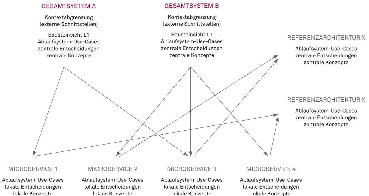
Abbildung 2: Aufbau der Architekturdokumentation in einer heterogenen Microservices-Landschaft
